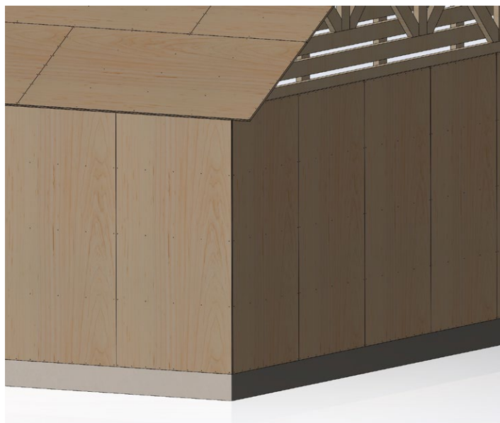
Rys. 13 Montaż płyt sklejkowych na konstrukcji ścian
