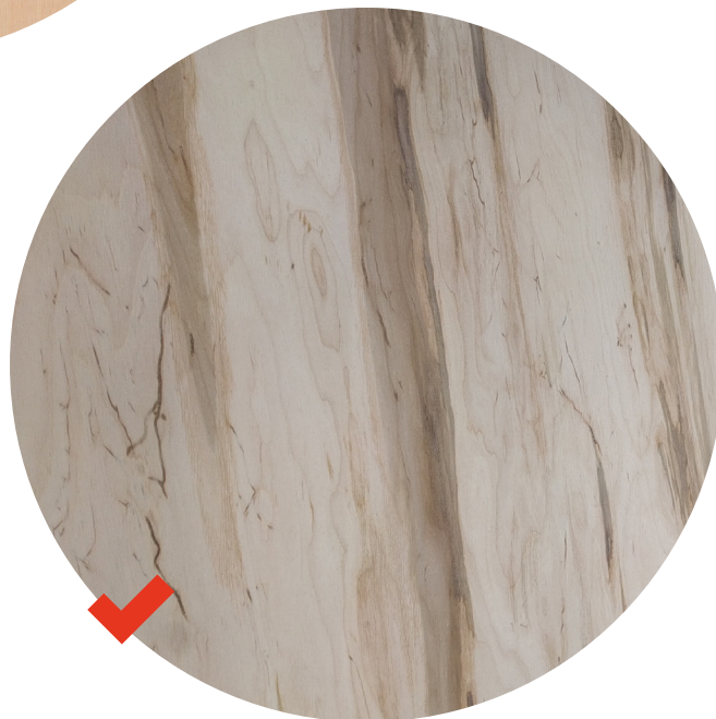
przebarwienie niepowodujące niszczenia drewna
