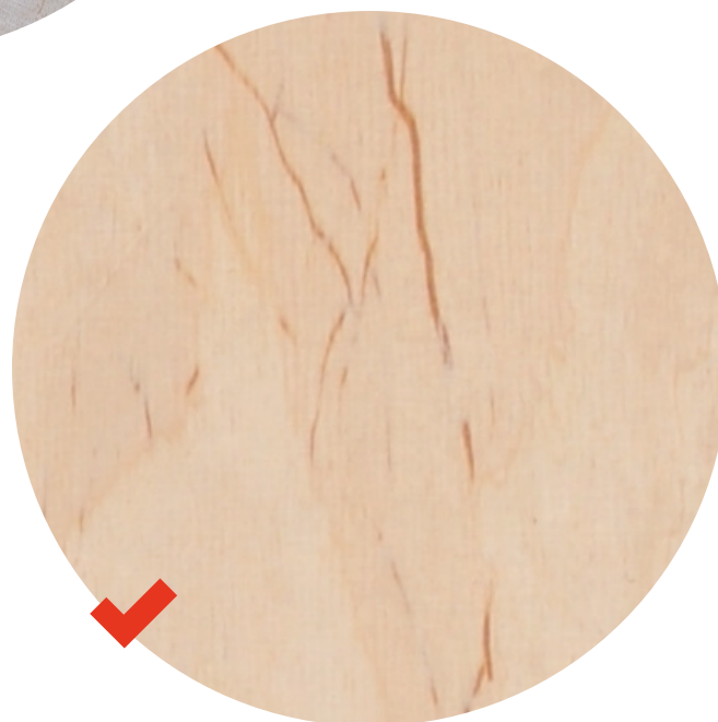
przebarwienia niepowodujące niszczenia drewna
