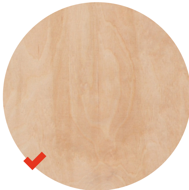
przebarwienie niepowodujące niszczenia drewna
